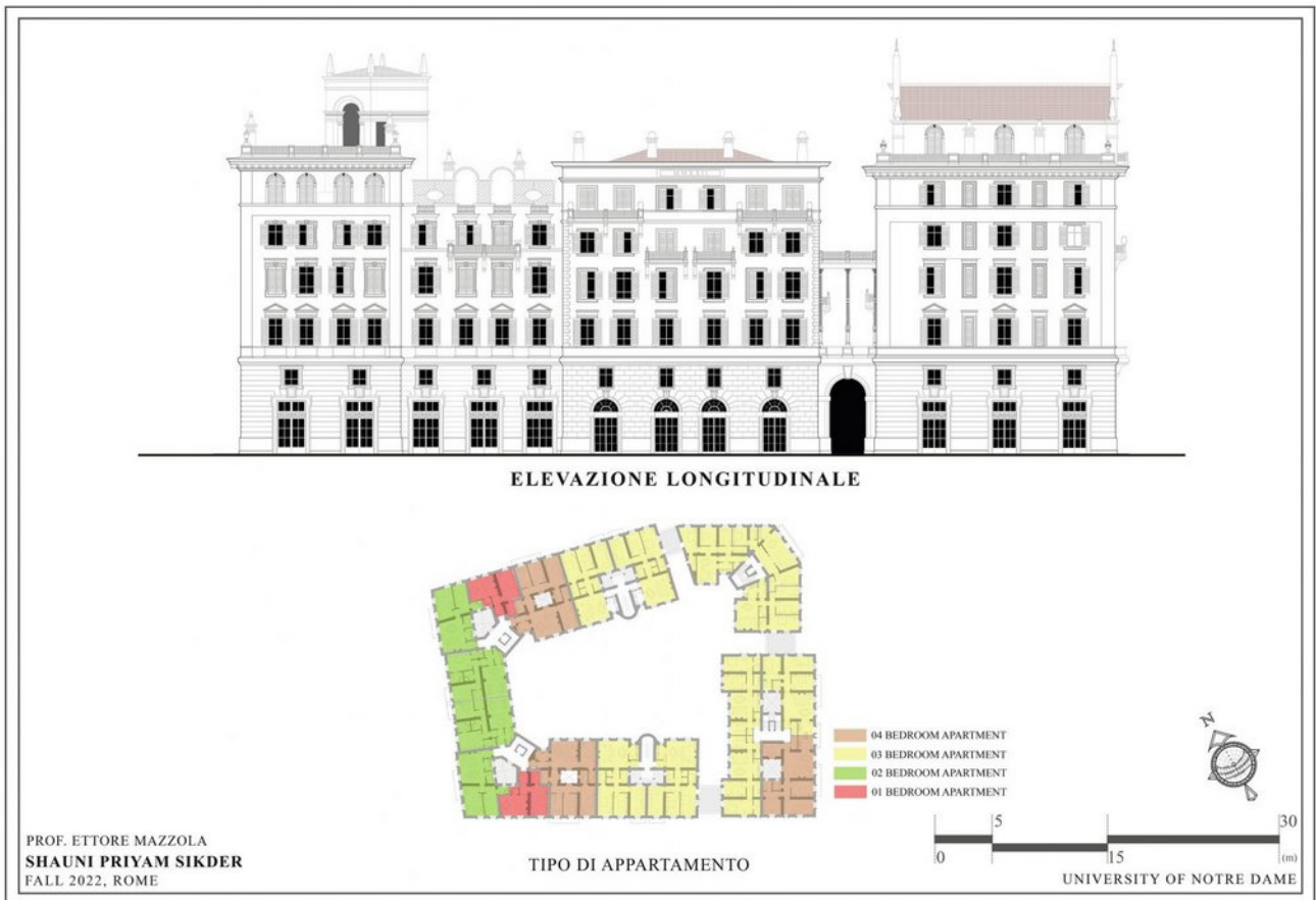
Shauni Priyam Sikder — Isolato residenziale misto sulla piazza principale. Prospetto sulla Piazza, Prospetto laterale e suddivisione degli edifici e appartamenti
