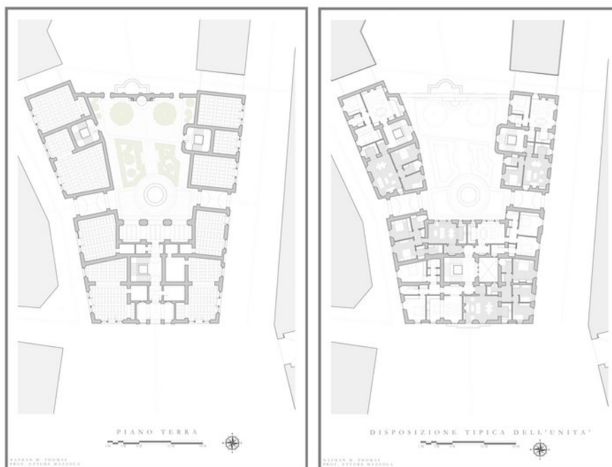
Nathan Thomas — isolato residenziale misto nella piazza principale. Pianta del Piano Terra e Pianta del Piano Tipo
