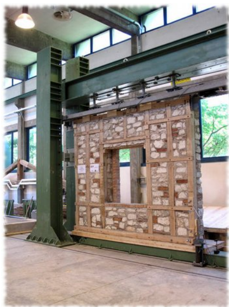
Esperimento antisismico su una parete costruita secondo il Codice antisismico borbonico del 1785.
